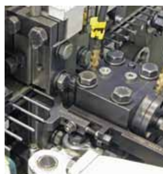
▲ Festhalten des Drahtstiftrohlings mit Pressionsbacken und Anstauchen des Nagelkopfes
